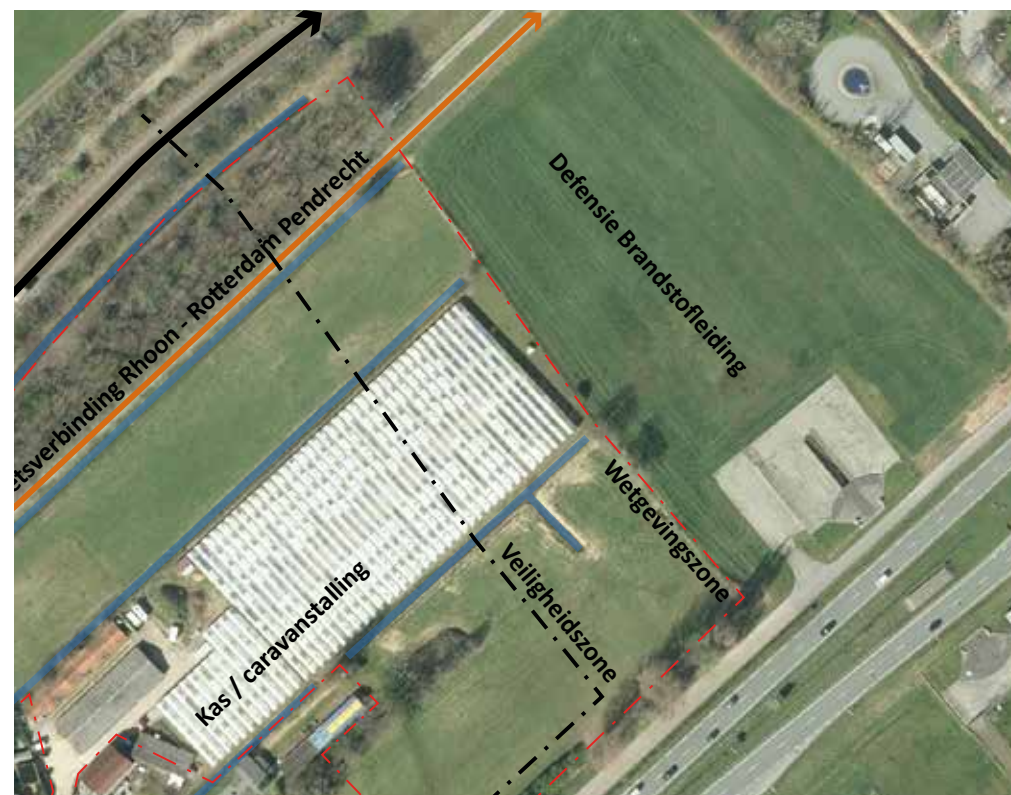
Luchtfoto met locatie brandstofleiding en veiligheidszone
