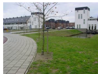
onvoldoende afstand tot verharding; voldoende ruimte beschikbaar
