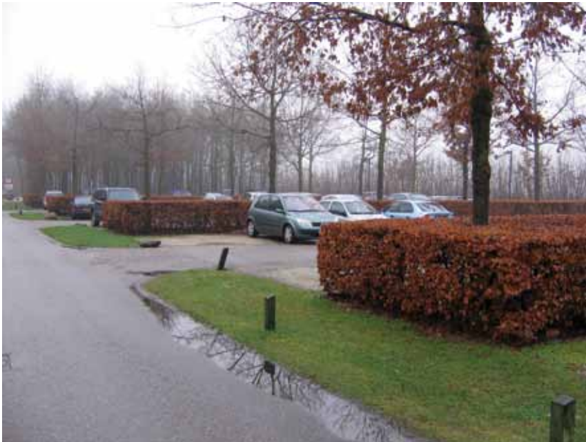
referentie voor de parkeerplaatsen met halfverharding in de parkeervakken en een haag die de auto's uit het zicht haalt (er komen geen hagen op het multifunctioneel parkeerterrein)
