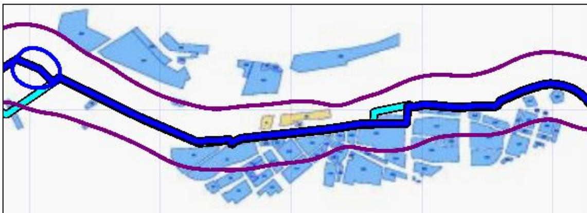
Afbeelding 6: Plaatsgebonden risico voor de gasleiding A-559.
