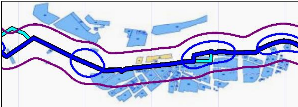
Afbeelding 5: Plaatsgebonden risico voor de gasleiding A-517.
